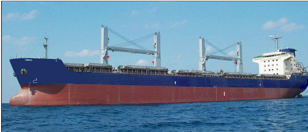
Figura A.01 – Estiba de grúas
