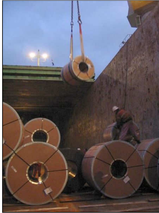
Figura C.01 – Estiba de bobinas en bodega
