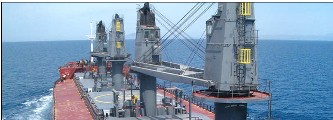
Figura A.02 – Estiba de grúas
