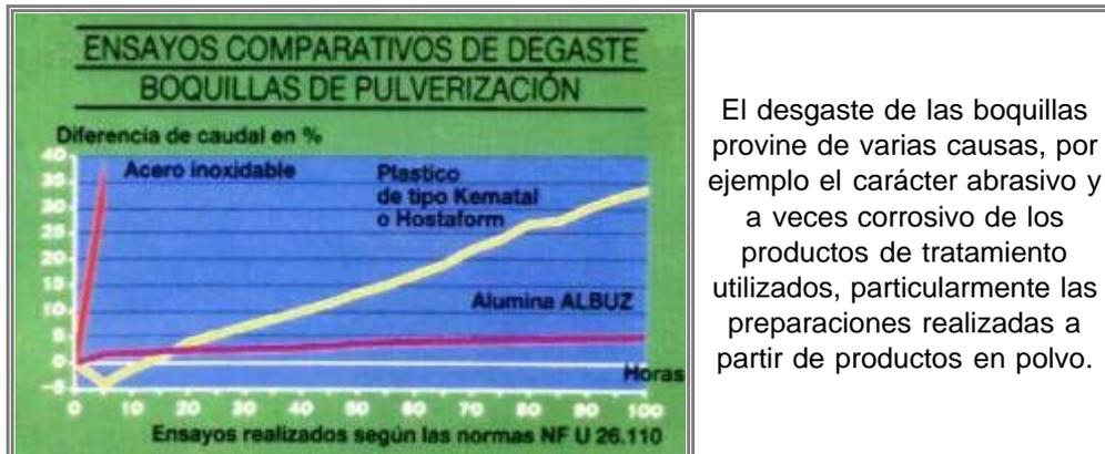
Estos productos alteran el orificio de la boquilla aumentando su diámetro de salida, por lo tanto deteriorando su ángulo, caudal, y reparto. En la siguiente fotografía se muestran los más recientes ensayos realizados por ALBUZ en donde se aprecian importantes disparidades según los ángulos.
